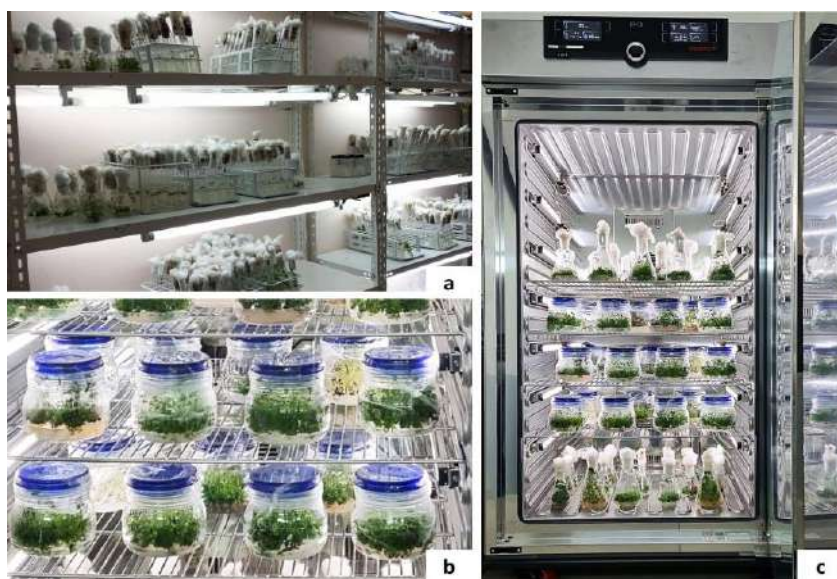
Figura 1.2. a) Dhomë vegjetative klasike me parametra fizikë të kontrolluar b, c) Inkubator i rritjes vegjetative (Laboratori i kulturave qelizore dhe indore, Departamenti i Bioteknologjisë, FSHN, UT)
