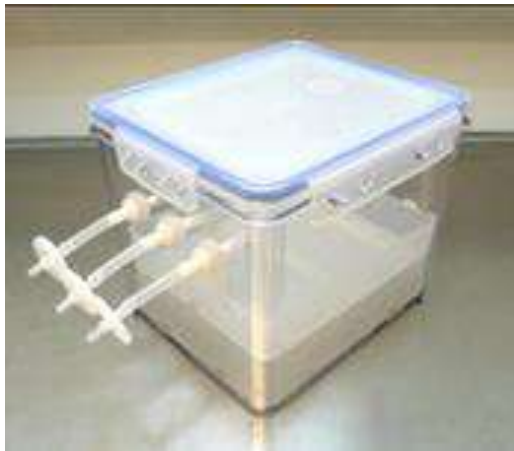
Figura 2.11. Pjesët përbërëse të bioreaktorit Plantform
