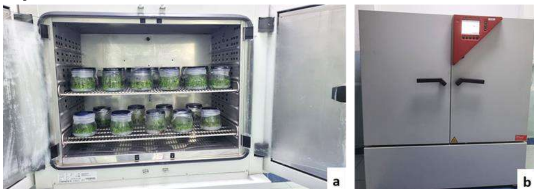
Figura 12.1. Konservimi në temperaturë 2 - 8^{\circ}\text{C} në errësirë a) Enë kulture të inkubuara në këto kushte b) Inkubatori i konservimit në 2 - 8^{\circ}\text{C} (Laboratori i kulturave qelizore dhe indore, Departamenti i Bioteknologjisë, FSHN, UT)
