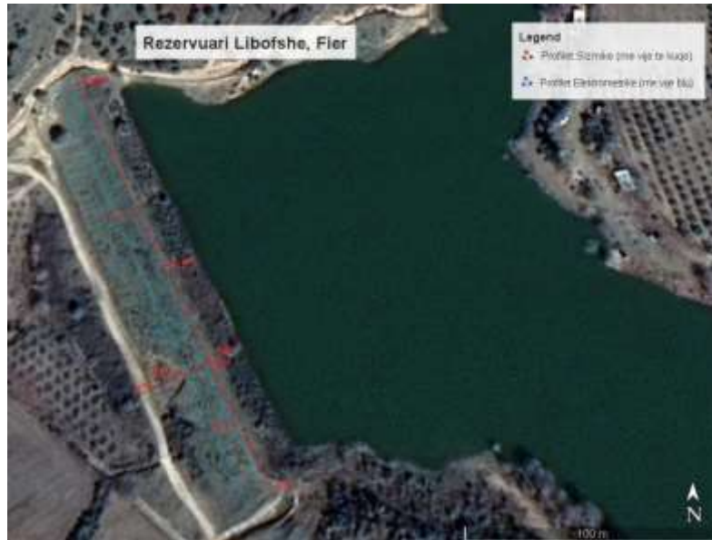
Fig. [10]. Vendosja e profileve sismikë në digën e rezervuarit të Libofshës, Fier. (me ngjyrë të kuqe, Google Earth)
