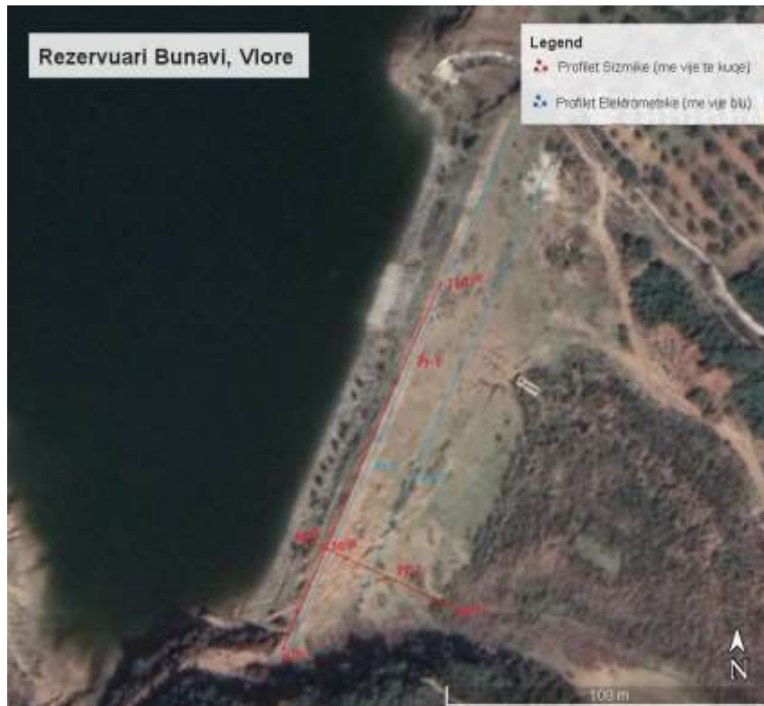
Fig.[6]. Vendosja e profileve sizmike në digën e rezervuarit të Bunavisë, (me ngjyrë të kuqe, Google Earth)
