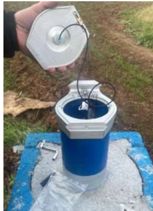
Foto 1 Pusi monitorues dhe pamja e instalimit të sensorit
