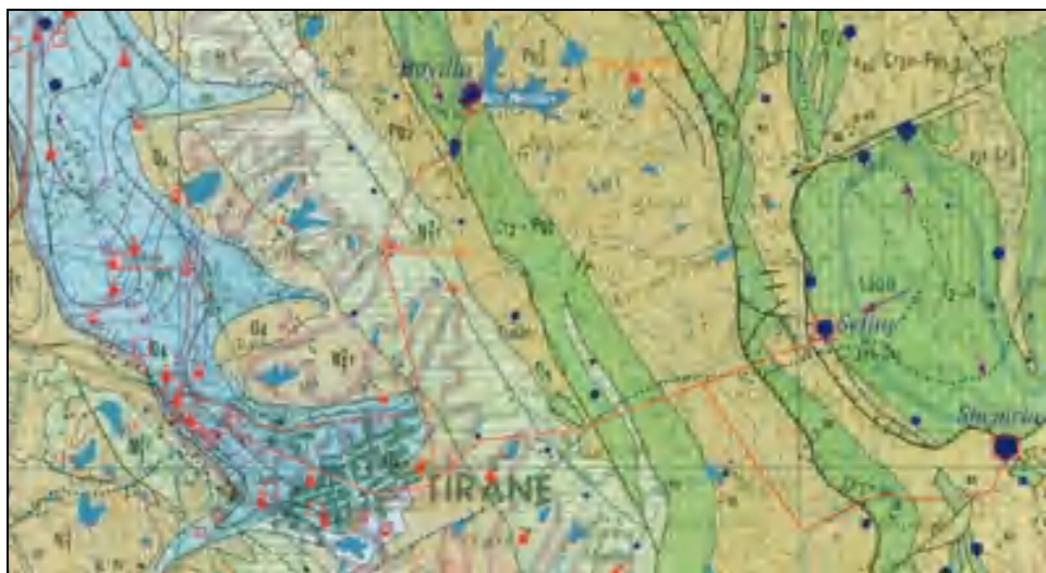
Fig. 8 Harta hidrogeologjike e zonës të Tiranës. Shtresat ujëmbajtëse të pasura që përdoren për furnizimin me ujë të Tiranës (Eftimi etj. 1985): fusha blu e errët - zhavorre lumore; fusha e gjelbër e errët - shtresa karstike. Shenja të tjera: kuadrat i kuq – burim që përdoren për furnizim me ujë ose stacione pompimi në shtresat zhavorrore; vijat e kuqe – linjë ujësjellësi
